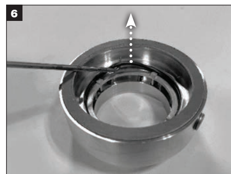
6 Remova o O-ring (X) da ranhura para O-ring da sobreposta e jogue-o fora.
