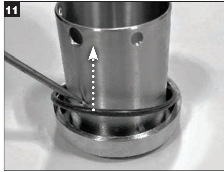
11 Remova o O-ring (W) da ranhura para O-ring da luva e jogue o O-ring fora.
