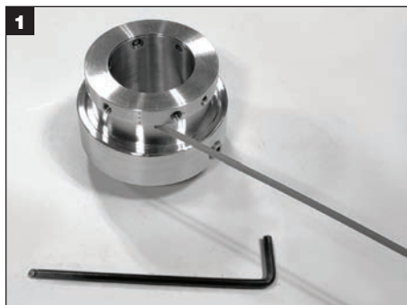
1 Ferramentas necessárias para a desmontagem do selo: chave sextavada ( fornecida com o selo ); pinças e uma ferramenta fina de ponta curva ( fornecidas pelo cliente, para a remoção dos O-rings ).
