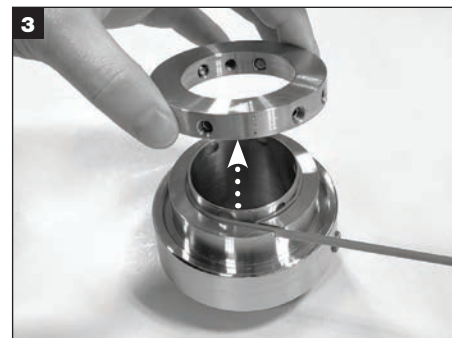
3 Remova o anel de trava da luva e deixe-o de lado. Remova a cinta de centralização.
