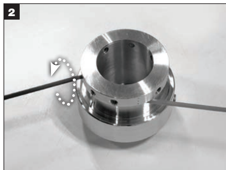
2 Remova todos os parafusos sextavados de ponta cônica e os parafusos sextavados internos sem cabeça de 1/4, e jogue-os fora.
